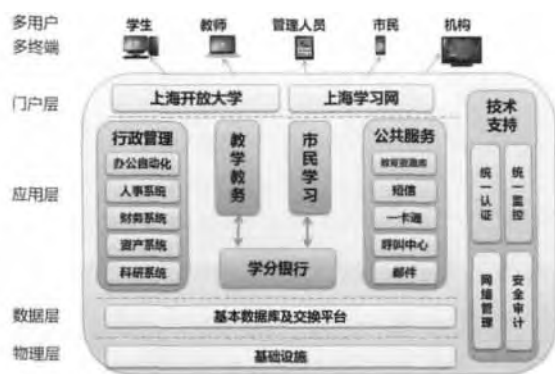
图1 上海开放大学信息化服务平台架构示意图
